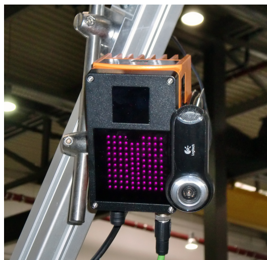
Abbildung 3.3: Sensorkopf bestehend aus ifm efector O3D200 und Logitech QuickCam Pro 9000.
