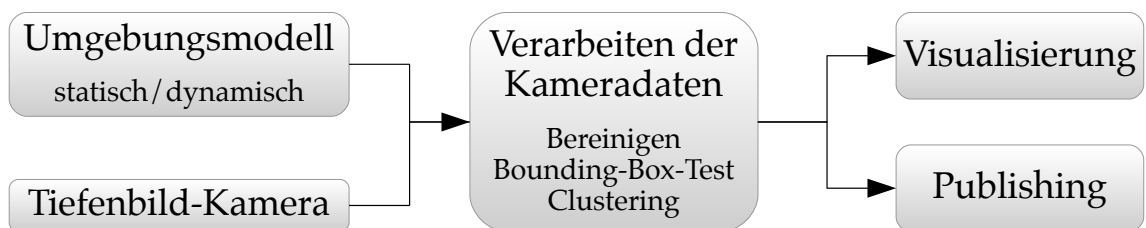
Abbildung 2.1: Gesamtkonzept einer Komponente zur aktiven Arbeitsraumüberwachung mittels Tiefenbild-Kameras.
